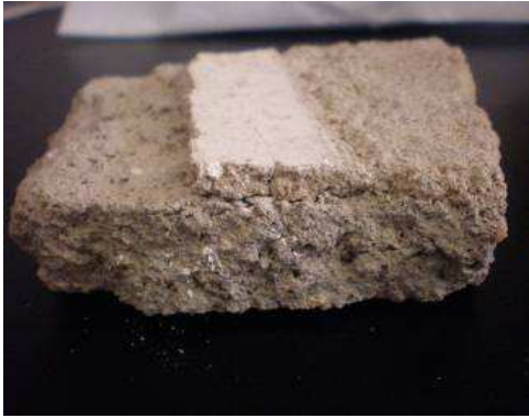
Fig. 10 – Argamassa de cal “parda” (cal dolomítica)
