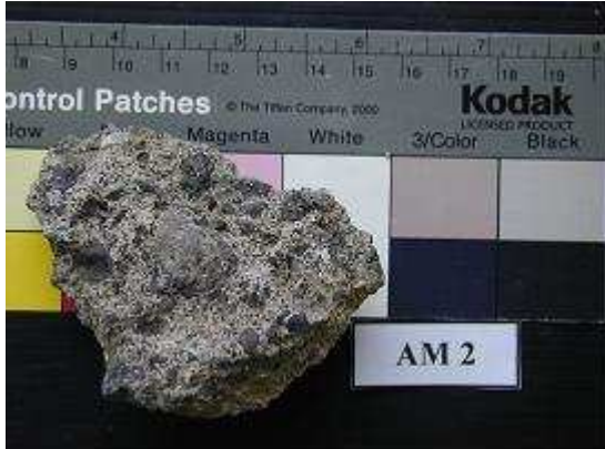
Fig. 12 - Argamassa de S. Miguel, Açores, com agregado vulcânico (Foto de Santos Silva, LNEC).
